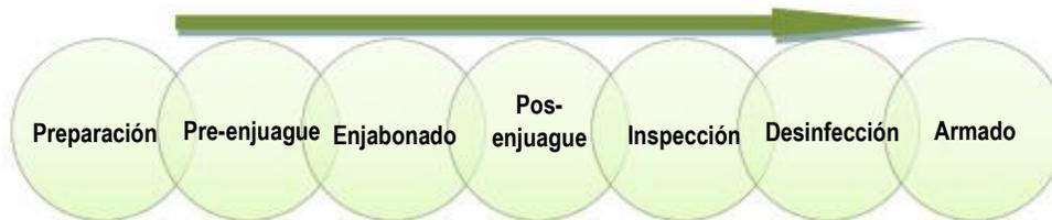
Para una limpieza y desinfección eficaz, se requiere usar productos químicos de grado alimenticio y seguir las indicaciones del fabricante. Es necesario evaluar y verificar la concentración y pH del producto químico para asegurar su eficacia. Debe evitarse el uso de agua a alta presión para reducir la posibilidad de diseminación de microorganismos.
